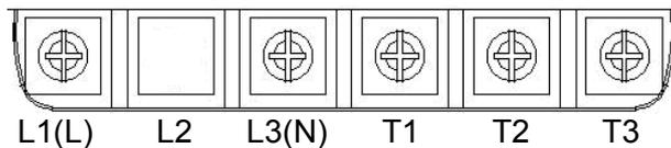
Hinweis: Bei Umrichtern mit einphasigem Anschluss fehlt an Klemme L2 die Schraube.
