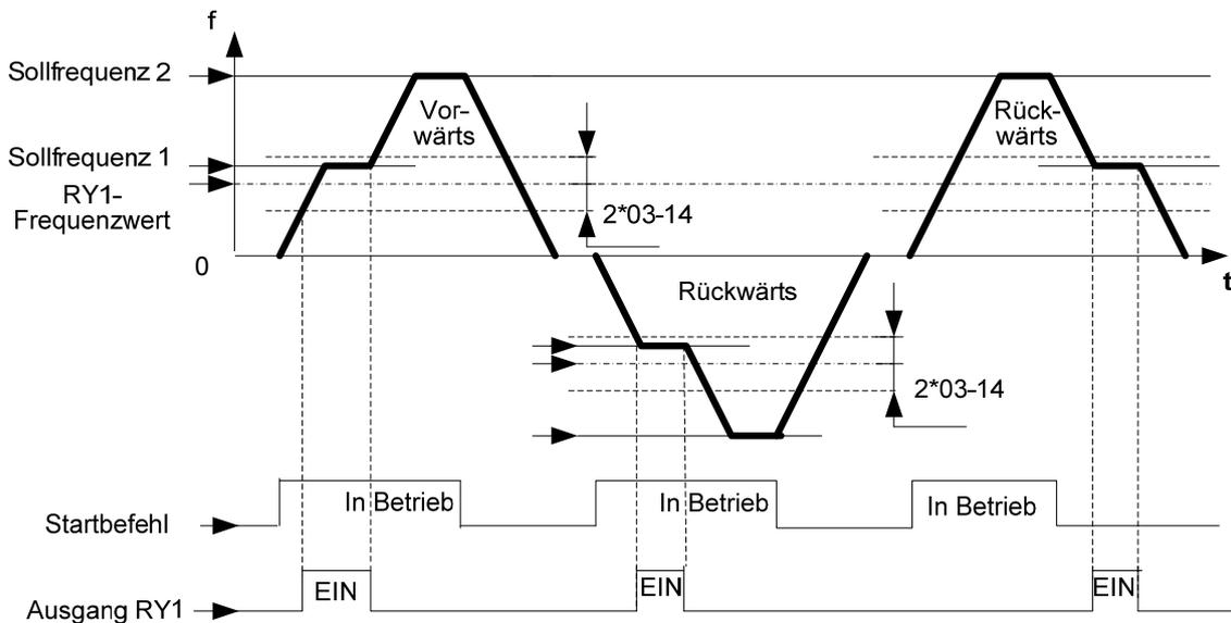
5) 03-11= **【4】** : RY1 wird eingeschaltet, sobald die Istfrequenz den mit Parameter 03-13 eingestellten Schwellwert übersteigt.
