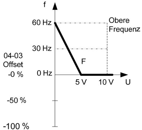
(3) In den Abbildungen 5 & 6 ist der Offset-Offset 0 % (04-03) und es werden die Auswirkungen bei Änderung von analoger Verstärkung (04-02), Offset-Typ (04-04) und Flankentyp (04-05) gezeigt.
