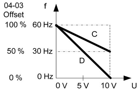
(2) In den Abbildungen 3 & 4 ist der Offset negativ (04-04 = 1) und es werden die Auswirkungen bei Änderung von Offset (04-03) und Flankentyp (04-05) gezeigt.
