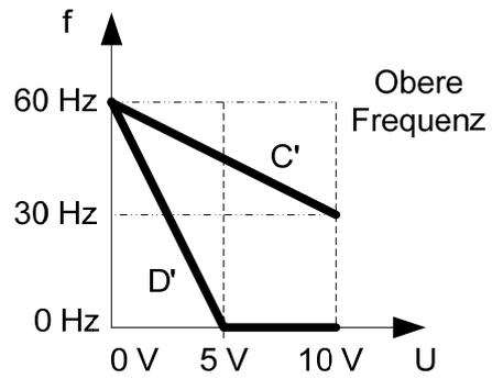
(4) In den folgenden Abbildungen 7, 8, 9 & 10 werden weitere Beispiele für Einstellungen und Änderungen der analogen Eingangsparameter gezeigt.
