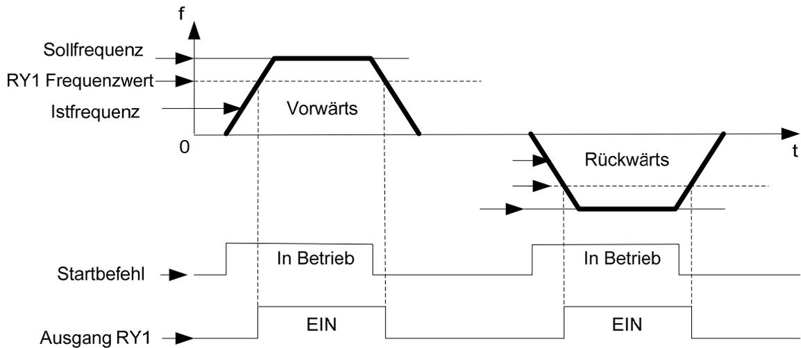
6) 03-11= **【5】** : RY1 wird eingeschaltet, sobald die Istfrequenz den mit Parameter 03-13 eingestellten Schwellwert unterschreitet.
