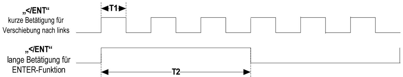
Durch eine kurze Betätigung der Taste wird der Wert des gewählten Parameters angezeigt. Durch eine lange Betätigung wird der blinkende Wert des Parameters gespeichert
