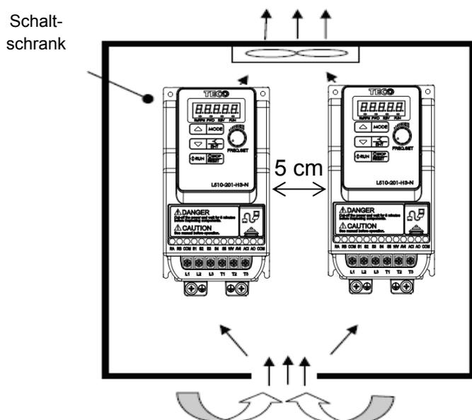
Halten Sie die notwendigen Mindestabstände ein und führen Sie die erzeugte Wärme durch einen Kühlventilator ab.
