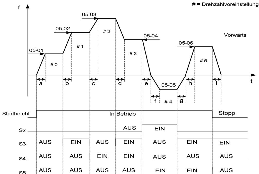
Für den Start des kontinuierlichen Betriebs können die Beschleunigungs- und Bremszeiten für jedes Segment wie folgt berechnet werden:-
