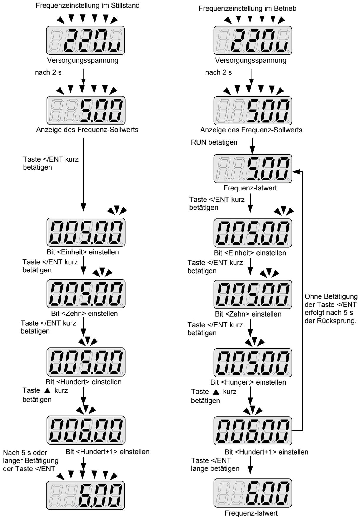
Hinweis: Die einstellbare Frequenz ist durch die minimale und maximale Ausgangsfrequenz begrenzt.
