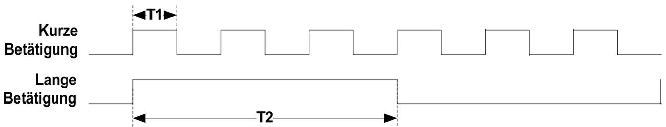
Eine kurze Betätigung der Tasten bewirkt eine Erhöhung/Verringerung der gewählten Stelle um 1. Eine lange Betätigung bewirkt eine kontinuierliche Erhöhung/Verringerung der gewählten Stelle.
