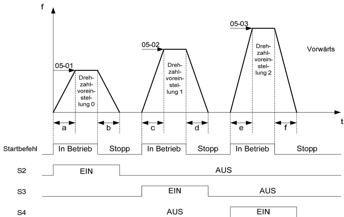
Ist der Start-Befehl ein/aus, können die Beschleunigungs- und Bremszeiten für jeden Zyklus wie folgt berechnet werden:- Die Zeiteinheit ist Sekunden
