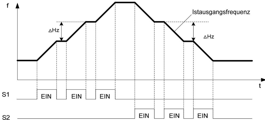
Modus 2: Wenn die Eingangsklemme für „Hochlauf“ oder „Bremsen“ länger als 2 Sekunden eingeschaltet wird, erfolgt die Frequenzänderung im originalen Hochlauf-/Bremsen-Modus. So lange, wie die Eingangsklemme eingeschaltet bleibt, steigt die Frequenz dem folgenden Diagramm entsprechend rampenförmig an bzw. ab.
